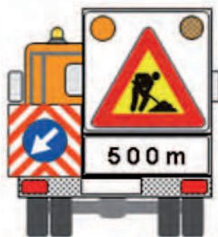
Esempi di presegnalazione di cantiere mobile in corsia di emergenza, il pannello segnaletico con appendice distanziometrica deve in ogni caso contenere un triangolo "lavori in corso" con lato 120 cm. e, nel caso dell'autocarro, essere integrato con lampade led M200 gialle omologate cl. L8H e certificate "CE" ad elevata efficienza.
