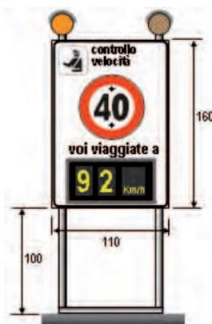
Dissuasore su cavalletto con rivelatore radar di velocità.
